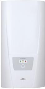
Elektronisch gesteuerter Durchlauferhitzer zur Warmwasserversorgung von einer oder mehreren Entnahmestellen. Die Elektronik steuert die Leistungsaufnahme in Abhängigkeit von Zulauftemperatur und Durchfluss bis zur Leistungsgrenze, um die eingestellte Wassertemperatur konstant zu halten. Durch Tastendruck kann zwischen den Solltemperaturen 35, 45 und 55 °C gewechselt werden. Die gewählte Solltemperatur wird durch unterschiedlich farbige LEDs angezeigt.
