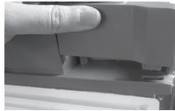
23. Schieben Sie die Kabelabdeckung oben auf die Kühlschrantür und drücken Sie sie vollständig hinein.
