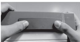
25. Entfernen Sie die Dichtungen an der Gerätetür, drehen Sie sie um 180° und befestigen Sie sie wieder.
