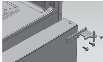
b) Til de deur van de vriezer ca. 50 mm omhoog om deze van het apparaat af te halen
