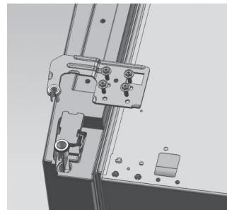
c) Draai de 2 schroeven los zoals in de afbeelding aangegeven om de afdekplaat van het gat aan de bovenkant van het apparaat te verwijderen.
