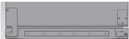
Finalement, vérifiez le bon alignement des portes et leur fermeture hermétique. Si nécessaire, ajustez les pieds ajustables de l'avant afin d'obtenir un positionnement bien horizontal de l'appareil.
