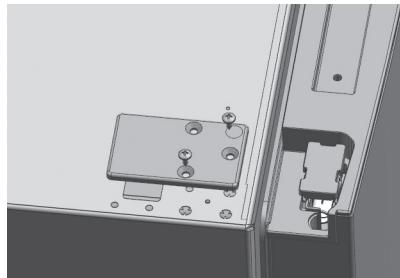
d) Til de koelkastdeur ca. 50 mm omhoog om deze vervolgens van het apparaat af te halen.
