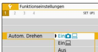
Wählen Sie auf der Registerkarte [F1] die Option **[Autom. Drehen]** und drücken Sie die Taste <SET>. Im Folgenden werden die verfügbaren Einstellungen beschrieben. Wählen Sie diese Option und drücken Sie <SET>.
