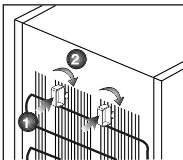
2. Bitte bringen Sie die beiden Kunststoffkeile wie in der Abbildung gezeigt an. Die Kunststoffkeile sorgen für den richtigen Abstand zwischen Kühlschrank und Wand – und damit für die richtige Luftzirkulation. (Die Abbildung dient lediglich zur Orientierung und muss nicht exakt mit Ihrem Gerät übereinstimmen.)
