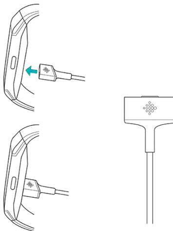
3. Die Stifte am Ladekabel müssen sicher in der Buchse einrasten. Die Verbindung ist sicher, wenn die Uhr vibriert und das Akkusymbol oder der Ladestand in Prozent auf dem Bildschirm erscheint.
