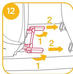
3. Richten Sie die Isosafe-Befestigungen mit den ISOFIX-Verankerungspunkten aus und rasten Sie beide Isosafe-Befestigungen in den ISOFIX-Verankerungspunkten ein. ⑬
