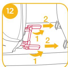
3. Alinee los conectores Isosafe con los puntos de anclaje ISOFIX y, a continuación, introduzca ambos conectores Isosafe en dichos puntos de anclaje hasta que escuche un clic. 13
