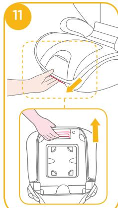
Drehen Sie die Isosafe-Befestigungen um 180 Grad bis sie in Richtung der ISOFIX-Führer zeigen. <sup>12</sup>
