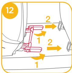
3. Alinhe os conectores ISO FIX com pontos de fixação ISO FIX, e, em seguida, clique nos conectores ISO FIX nos pontos de fixação ISO FIX. ⑬
