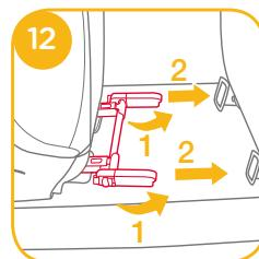
3. Lijn de Isosafe-aansluitingen uit met de ISOFIX-ankerpunten en klik beide Isosafe-aansluitingen in de ISOFIX-ankerpunten. 13
