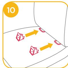
2. Presione el botón de ajuste Isosafe para extraer los conectores Isosafe. **11**
