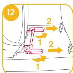
3. Alignez les connecteurs Isosafe avec les points d'ancrage ISOFIX, puis insérez les deux connecteurs Isosafe dans les points d'ancrage ISOFIX. 13
