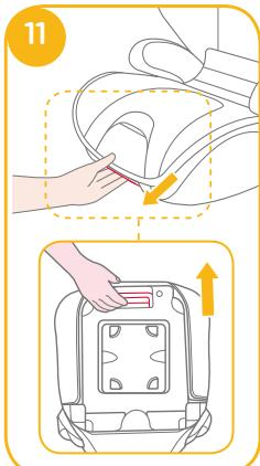
Gire os conectores Isosafe 180 graus, em seguid até apontar na direção dos guias ISO FIX. ⑫
