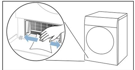
**Hinweis:** Achten Sie darauf, den freiliegenden Wärmetauscher nicht zu beschädigen.
