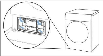
5. Wärmetauscher-Abdeckung am Griff herausziehen.
