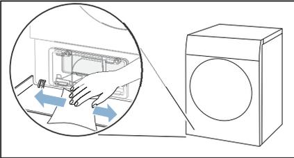
4. Hebel der Wärmetauscher-Abdeckung entriegeln.
