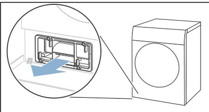
6. Filtermatte vorsichtig von der Wärmetauscher-Abdeckung ziehen.
