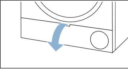
3. Wartungsklappe mit einem weichen, feuchten Tuch reinigen.
