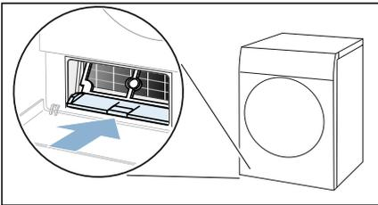
11. Wärmetauscher-Abdeckung am Griff einschieben.
