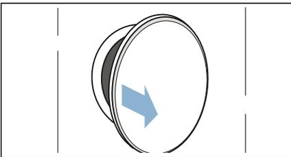
2. Feuchtigkeitssensor mit angerauhtem Schwamm reinigen.
