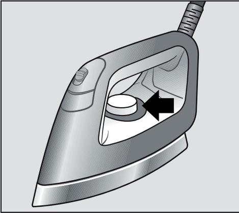
Die Bügeltemperatur wird mit dem Temperaturwähler am Bügeleisen eingestellt.
