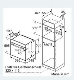
Wird das Gerät unter einem Kochfeld eingebaut, muss folgende Arbeitsplattenstärke (ggf. inkl. Unterkonstruktion) beachtet werden.
