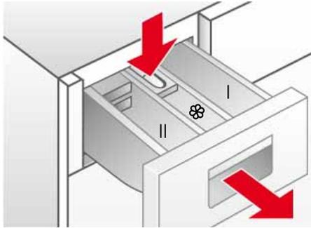
Die Waschmittelschublade ist in drei Kammern unterteilt
