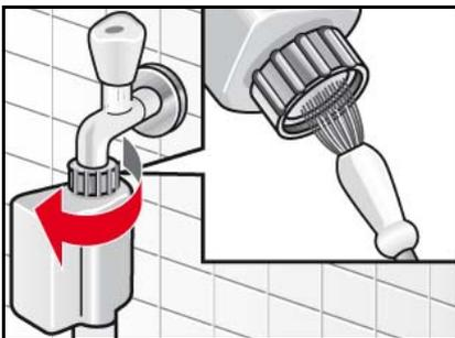
Wenn kein oder nicht genügend Wasser in den Waschtrockner einläuft, zunächst Wasserdruck im Zulaufschlauch abbauen:
