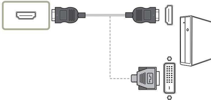
— Die Audiofunktion wird nicht unterstützt, wenn das externe Gerät mit dem HDMI-DVI-Kabel angeschlossen wird.
