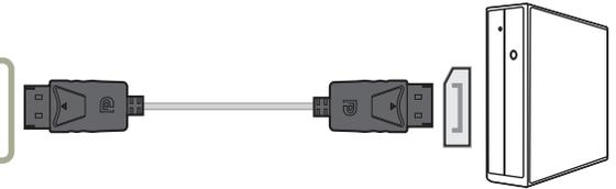
— Verwenden Sie möglichst ein DP-Kabel mit einer Länge von maximal 1,5 m. Wenn das Kabel länger als 1,5 m ist, kann die Bildqualität beeinträchtigt sein.
