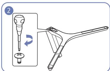
Drehen Sie die Befestigungsschraube unten am Standfuß bis zum Anschlag, damit er sicher befestigt ist.
