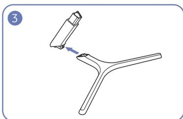
Nehmen Sie den Standfußanschluss aus dem Standfuß. Ziehen Sie ihn dazu in Pfeilrichtung (siehe Abbildung).
