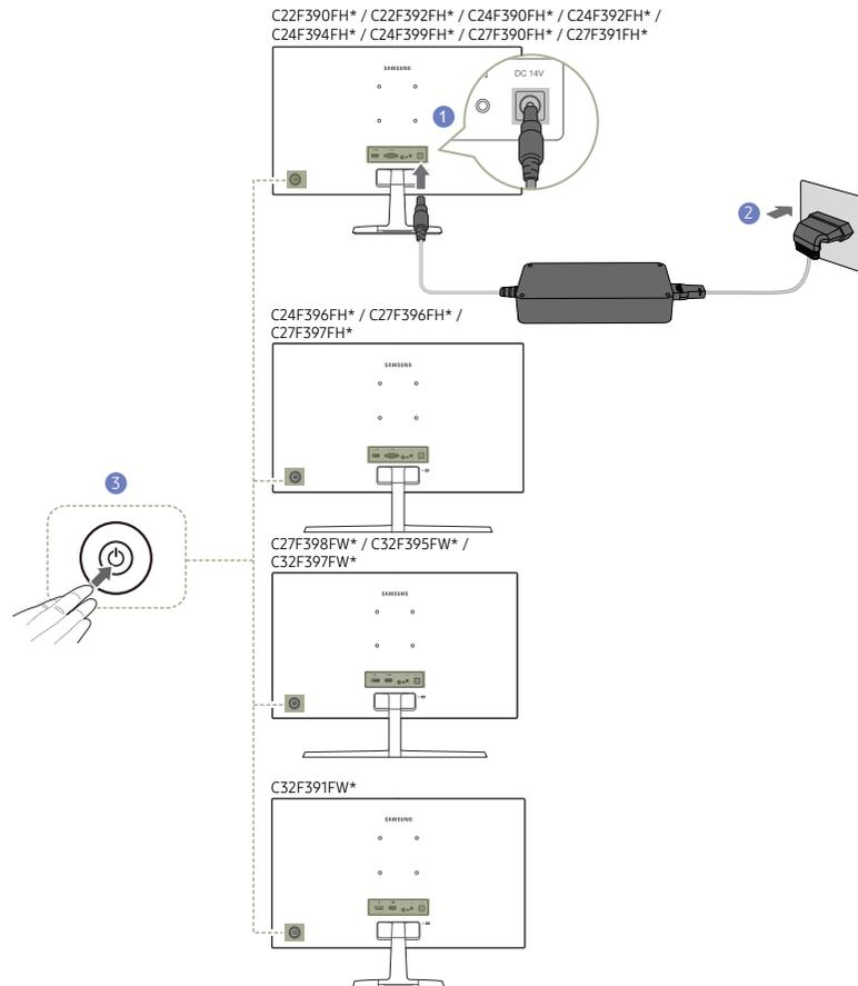
1 Verbinden Sie das Netzkabel mit dem AC/DC-Netzteil. Schließen Sie nun das AC/DC-Netzteil an den DC 14V-Anschluss an der Rückseite des Geräts an.
