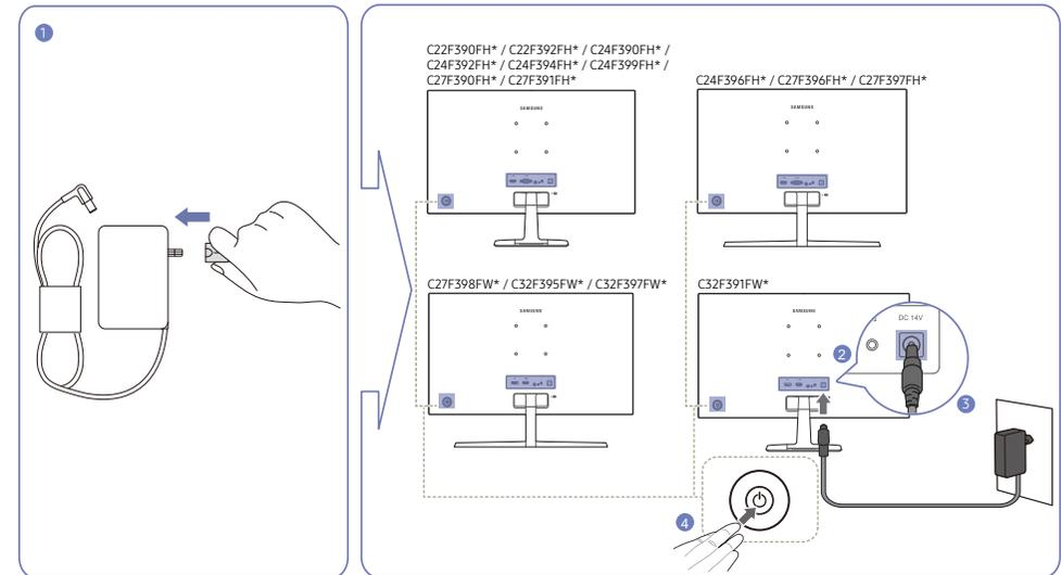
1 Verbinden Sie den Netzstecker mit dem AC/DC-Netzteil. (Zubehör)
