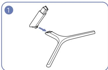
Setzen Sie den Standfußanschluss in der Richtung in den Standfuß, die in der Abbildung gezeigt ist. Vergewissern Sie sich, dass der Standfußanschluss fest verbunden ist.
