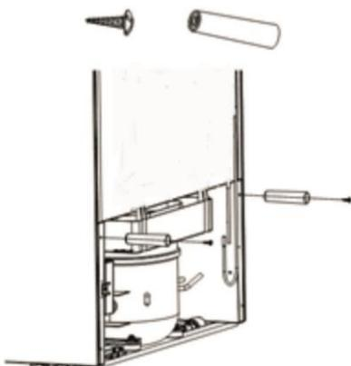
Zur Einhaltung der Abstände und zur Erreichung der angegebenen Energieklasse sind die beigegefügteten Abstandshalter am Gerät anzubringen. Sie werden direkt hinten am Gerät fixiert (siehe Zeichnung Fig.3).
