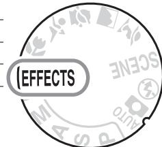
Die folgenden Effekte können Sie wählen, indem Sie das Funktionswählrad auf **EFFECTS** stellen und dann am Einstellrad drehen, bis der gewünschte Effekt auf dem Monitor erscheint.
