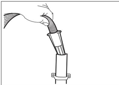
5. Ohne Kunststoffschlauchführung: Stecken Sie den Ablaufschlauch in den Siphon und befestigen Sie ihn mit einer Schlauchschelle. Orientieren Sie sich an der Abbildung.
