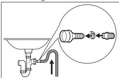
**i** Stellen Sie sicher, dass der Ablaufschlauch einen Bogen beschreibt, damit keine Partikel aus dem Siphon in das Gerät gelangen können.
