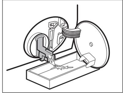
5. Wenn der Behälter voll ist, schließen Sie den Ablaufkanal und leeren Sie den Behälter.
