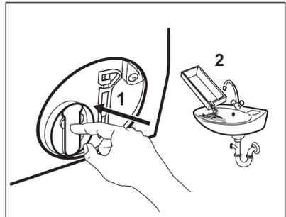
7. Schließen Sie den Ablaufkanal und drehen Sie das Sieb gegen den Uhrzeigersinn, um es zu entfernen.
