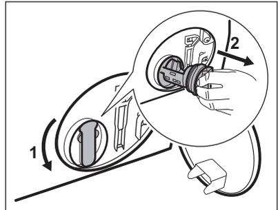
8. Entfernen Sie gegebenenfalls Flusen und Fremdkörper aus der Siebaufnahme.
