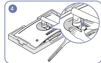
Heben Sie die RÜCKABDECKUNG OBEN auf der Rückseite des Monitors mit den Fingern in Pfeilrichtung an (siehe Abbildung).
