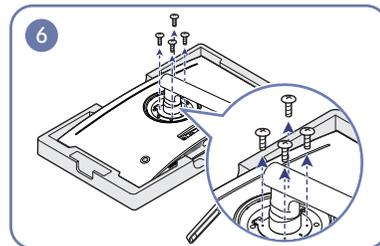
Lockern Sie, wie in der Abbildung gezeigt, die Schrauben am Standfuß.
