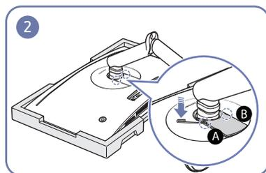
Führen Sie den dafür vorgesehenen Demontagestift in die Öffnungen **A** und **B** und verwenden Sie den Stift als Hebel zum Anheben der RÜCKABDECKUNG UNTEN.
