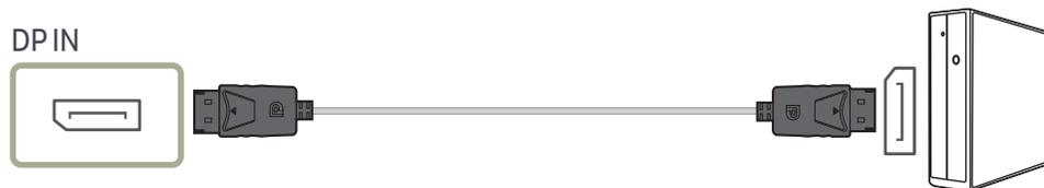
Verwenden Sie möglichst ein DP-Kabel mit einer Länge von maximal 1,5 m. Wenn das Kabel länger als 1,5 m ist, kann die Bildqualität beeinträchtigt sein.
