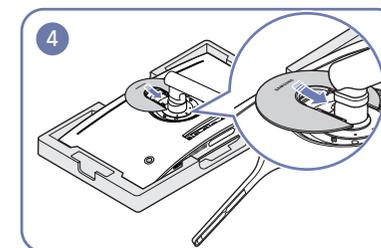
Richten Sie die RÜCKABDECKUNG OBEN auf der Rückseite des Monitors aus und drücken Sie sie in Pfeilrichtung in die Rille.
