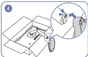
Bringen Sie den Standfuß wie im Bild gezeigt an dem Halsstück an. Stellen Sie sicher, dass zwischen dem Standfuß und dem Halsstück keine Lücke übrig bleibt.
