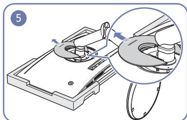
Entfernen Sie die RÜCKABDECKUNG OBEN in Pfeilrichtung.
