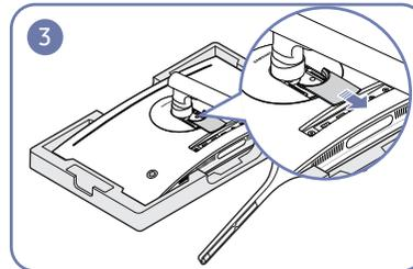
Entfernen Sie die RÜCKABDECKUNG UNTEN in Pfeilrichtung.
