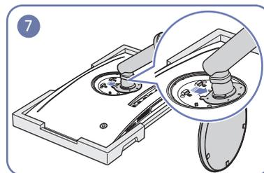
Heben Sie den Standfuß an und entfernen Sie ihn.
