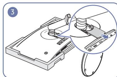
Entfernen Sie die RÜCKABDECKUNG UNTEN in Pfeilrichtung.
