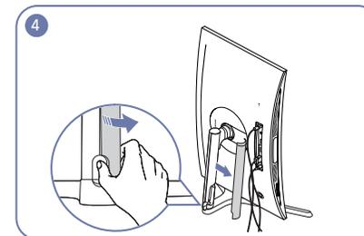
Öffnen Sie die LINKE ABDECKUNG DER STANDFUSSHALTERUNG und drehen Sie den offenen Teil nach unten.
