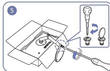
Verbinden Sie den Standfuß mit der Halterung für den Standfuß und bringen Sie anschließend die zwei Schrauben am Fuß an, um ihn fest zu montieren.
