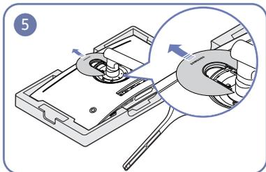
Entfernen Sie die RÜCKABDECKUNG OBEN in Pfeilrichtung.
