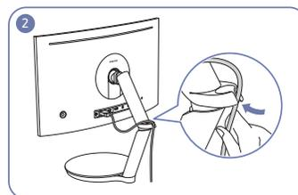
Führen Sie die Kabel in Pfeilrichtung vom unteren Teil der Halterung aus durch die Halterung (siehe Abbildung).
