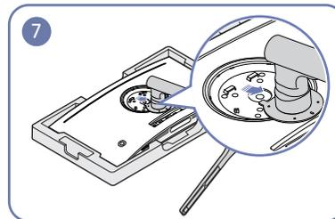
Heben Sie den Standfuß an und entfernen Sie ihn.
