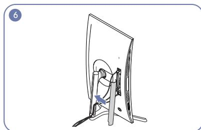
Decken Sie die LINKE ABDECKUNG DER STANDFUSSHALTERUNG ab. Drehen Sie das Gerät in die horizontale Position.
