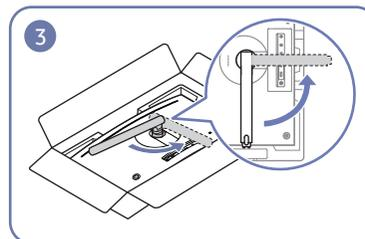
Drehen Sie das Halsstück des Standfußes 90° im Gegenuhrzeigersinn und bewegen Sie den Verbindungsbereich über den Rand der Verpackung.
