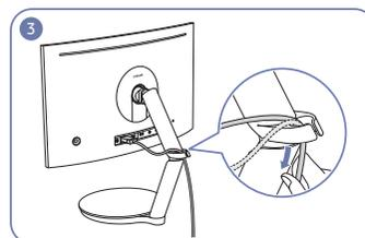
Ziehen Sie die Kabel nach unten, um die Länge anzupassen.
