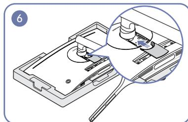
Richten Sie die RÜCKABDECKUNG UNTEN auf der Rückseite des Monitors aus und drücken Sie sie in Pfeilrichtung in die Rille.
