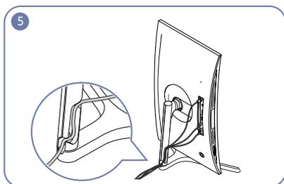
Führen Sie die entsprechenden Kabel durch die Halterung für den Standfuß. Zerren Sie nicht an dem Kabel. Es werden drei Kabel in einer Halterung empfohlen.
