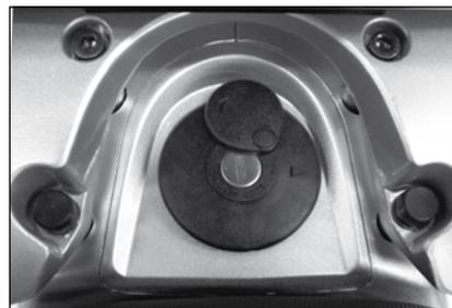
**Treibstoff:** Normal oder Super Treibstoff (bleifrei), 90 Oktan oder höher verwenden. Verunreinigungen im Treibstoff können den Motor beschädigen oder zerstören.
