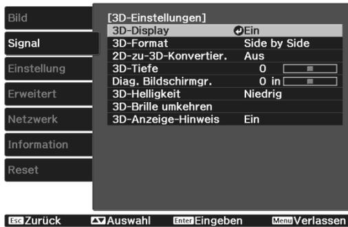
**3** Wählen Sie **2D-zu-3D-Konvertier.** und drücken Sie anschließend die Taste **Enter** zur Bestätigung.
