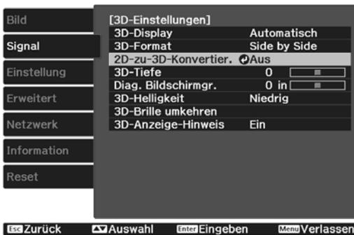
**4** Wählen Sie die Stärke des 3D-Effekts aus, und drücken Sie anschließend **Enter** zur Bestätigung.
