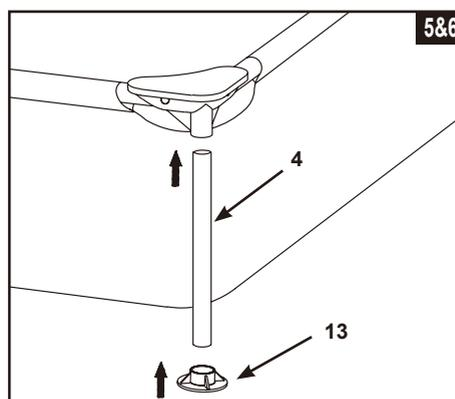
7. Ziehen Sie die Bodengurtbänder unter der Poolfolie heraus. Verbinden Sie die Seitenstützen in Form eines umgekehrten „Y“ (9) mit den T-Verbindungen (7) und fixieren Sie diese mit den bereits eingebauten V-förmigen Clips. Richten Sie die Löcher der Bodengurtbänder an den unteren Enden der Seitenstützen (9) aus. Befestigen Sie die Fußkappen (13) der Seitenstützen am unteren Ende (siehe dazu Zeichnung 7).
