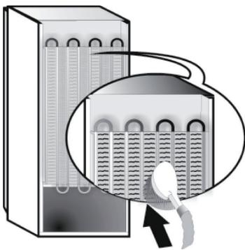
Für einen kontinuierlichen und korrekten Tauwasserablauf die Abflussöffnung an der Kühlraumrückwand in der Nähe des Obst- und Gemüsefachs mit dem mitgelieferten Werkzeug regelmäßig reinigen.
