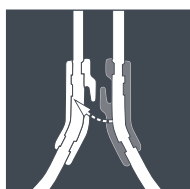
Gancio per il collegamento laterale delle sedute
