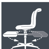
Repose-pieds pivotant à 360°
