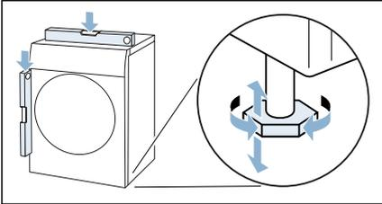
3. Falls notwendig, Gerät neu ausrichten durch Drehen der Gerätefüße. Sie können das Gerät jetzt anschließen.
