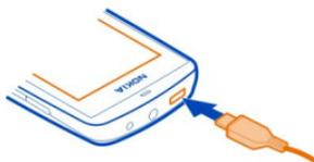
Wenn sich keine Netzsteckdose in der Nähe befindet, können Sie Ihr Gerät auch über USB aufladen. Während das Gerät aufgeladen wird, können Daten übertragen werden. Die Effizienz der Ladung über USB variiert deutlich und es kann eine Weile dauern, bis der Ladevorgang gestartet wird und das Gerät die Arbeit aufnimmt.
