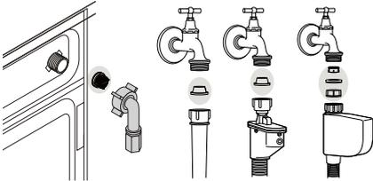
Am Endstück jedes Wasserzulauffentils an der Rückseite der Maschine sowie am Ende der Wasserzulauffschläuche (dort, wo diese an den Wasserhahn angeschlossen werden) befindet sich ein Filter. Diese Filter verhindern, dass Fremdkörper und Schmutz mit dem Wasser in die Waschmaschine gelangen. Die Filter sollten bei Verschmutzung gereinigt werden.
