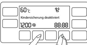
Halten Sie die **2. und 4. Zusatzfunktionstaste** 3 Sekunden lang gedrückt. Nach Ablauf des Countdowns („Kindersicherung 3-2-1“) im Display wird „Kindersicherung deaktiviert“ angezeigt.
