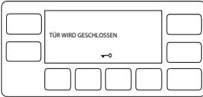
Ein spezielles Sicherheitssystem verhindert das Öffnen der Tür, solange der Wasserpegel innerhalb der Maschine noch nicht als sicher gilt.
