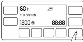
**Falls der Wasserstand in der Maschine dies bei Betätigung der Start/Pause**-Taste zulässt, erscheint „Tür öffnen“ im Display.
