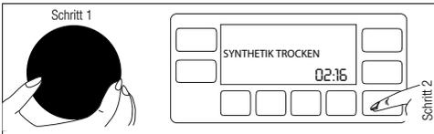
Mit diesem Programm trocknen Sie nasse oder feuchte Synthetikwäsche, deren Trockengewicht 4 kg entspricht. Dieses Programm führt nur eine Trocknung durch.
