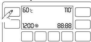
Sobald Sie ein neues Programm auswählen, wird die für das jeweilige Programm empfohlene Waschtemperatur in der Temperaturanzeige angezeigt. Möglicherweise ist die empfohlene Temperatur nicht die Maximaltemperatur, die beim aktuellen Programm ausgewählt werden kann.
