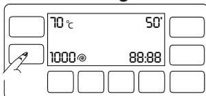
Nachdem Sie ein Programm ausgewählt haben, wird die empfohlene Schleudergeschwindigkeit des gewählten Programms in der **Schleudergeschwindigkeits** anzeige dargestellt.
