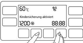
Halten Sie die **2.** und **4. Zusatzfunktionstaste gemeinsam** 3 Sekunden lang gedrückt. Nach Ablauf des Countdowns („Kindersicherung 3-2-1“) im Display wird „Kindersicherung aktiviert“ angezeigt. Lassen Sie die **2.** und **4. Zusatzfunktionstaste los**, wenn diese Warnung angezeigt wird.
