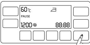
**Halten Sie die Maschine durch Drücken der Start/Pause**-Taste an. Der Rahmen der **Start/Pause**-Taste beginnt zu blinken. „Pause“ erscheint im Display.
