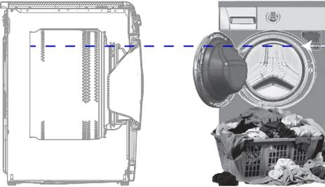
Beim Zyklus 6 kg waschen & trocknen empfehlen wir, die Wäsche nur bis zur der obigen Abbildung gezeigten Markierung (bei geöffneter Gerätetür) einzufüllen, damit die Wäsche richtig trocken wird.
