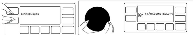
1. Halten Sie zum Aufrufen des Einstellungsmenüs 3 Sekunden **Temperatur einstellaste** und **Schleudergeschwindigkeit-Einstelltaste** gedrückt. Öffnen Sie mit der **Trocknungs** taste das „Lautstärkeeinstellung“-Menü.
