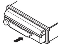
Wenn Sie das Bedienteil nicht erfolgreich am Hauptgerät anbringen können, versuchen Sie es erneut. Wenn Sie das Bedienteil mit Gewalt in Position drücken, kann das zu Schäden führen.
