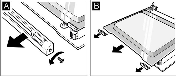
4. Halteklammern rechts und links aufschrauben. Scheibe anheben und Klammern von der Scheibe abnehmen (Bild C).
