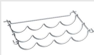
Das Flaschengitter ist gegen ungewolltes Herausziehen gesichert. Sie können das Flaschengitter nur herausziehen, wenn es leer ist, indem Sie es am hinteren Teil anheben und zu sich ziehen. Stellen Sie das Flaschengitter so in den Kühlschrank, dass das Schließen der Gerätetür durch die Flaschen nicht behindert wird.
