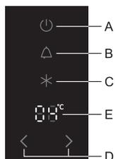
Bei überhöhter Temperatur im Geräteinneren wird ein akustischer Alarm (unterbrochener Ton) ausgelöst und die Taste **B** blinkt.
