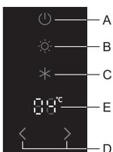
Bei überhöhter Temperatur im Geräteinneren wird ein Alarmsignal (**unterbrochenes akustisches Signal**) ausgelöst und der Temperaturindikator blinkt.
