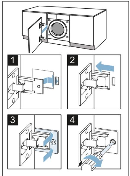
**11. Magnetschnapper am Gerät einsetzen.**
