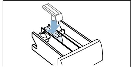
6. Gehäuse der Waschmittelschublade im Gerät reinigen.
