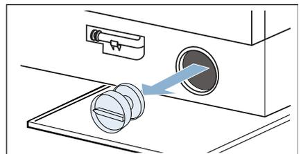
9. Innenraum, Gewinde des Pumpendeckels und Pumpengehäuse reinigen. Das Flügelrad der Laugenpumpe muss sich drehen lassen.
