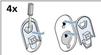
2. Alle 4 Hülsen einsetzen. Netzleitung kann an den Halterungen festgeklemmt werden.
