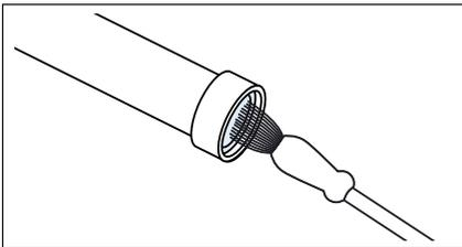
3. Bei Modellen Standard und Aqua-Secure Sieb an der Geräterückseite reinigen:
