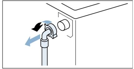
4. Bei Modellen Standard und Aqua-Secure Sieb an der Geräterückseite reinigen:
