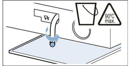
7. Entleerungsschlauch in die Halterung einsetzen.
