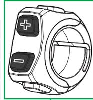
Das VADO ist mit mehreren Stufen der Motorunterstützung ausgestattet.
