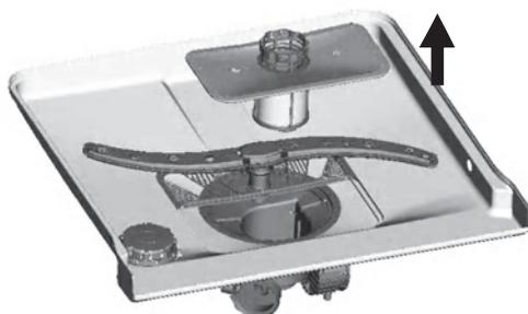
Schritt 2: Heben Sie das Filtersystem hoch.
