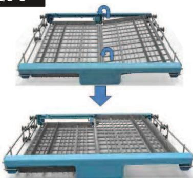
Position Nr. 3: Heben Sie die rechte Haltevorrichtung des Geschirrkorbess an: Die linke und die rechte Haltevorrichtung des Geschirrkorbess stehen nun waagrecht.
