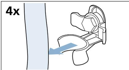
2. Alle 4 Transportsicherungsschrauben mit einem Schraubenschlüssel SW13 lösen und entfernen.
