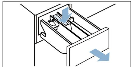
3. Dosierhilfe nach vorn schieben, herunterklappen und einrasten.
