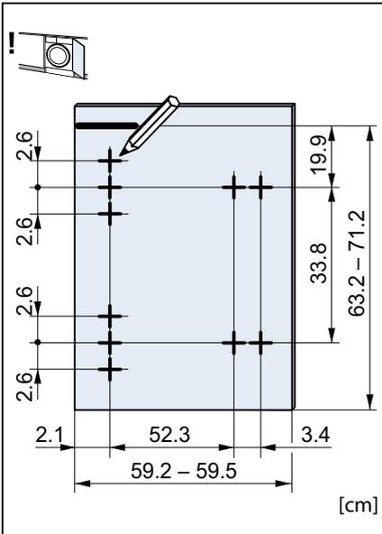
8. Löcher bohren. Für das Loch  $\varnothing$  35 mm einen Topfbohrer verwenden.
