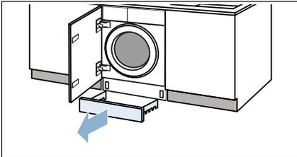
4. Entleerungsschlauch aus der Halterung nehmen.
