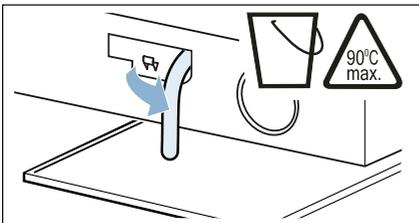
5. Verschlusskappe abziehen, Lauge in geeignetes Gefäß abfließen lassen.
