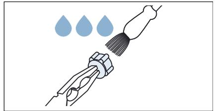
5. Schlauch anschließen und auf Dichtheit prüfen.
