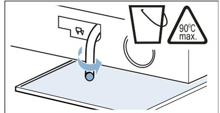
7. Entleerungsschlauch in die Halterung einsetzen.
