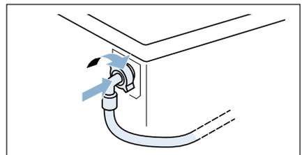
**Hinweis:** . Wasserhahn vorsichtig öffnen und dabei Dichtheit der Anschlussstellen prüfen. Schraubverbindungen stehen unter Wasserleitungsdruck.
