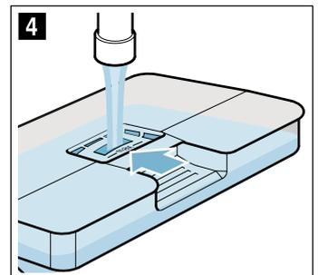
7. Abdeckung **a** wieder in die Öffnung am Wassertank einsetzen.
