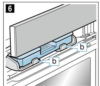
9. Blende langsam nach unten schieben, dann nach hinten drücken, bis sie vollständig geschlossen ist. Der Wassertank ist gefüllt. Sie können Betriebe mit Dampf starten.
