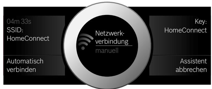
4. Mobiles Endgerät am Backofennetzwerk mit der SSID "HomeConnect" mit dem Key "HomeConnect" anmelden.
