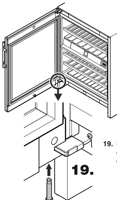
19. Den unteren Lagerbolzen in derselben Weise wie oben einsetzen.
