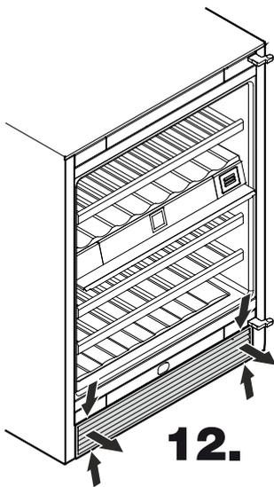
12. Lüftungsgitter an den angezeigten Punkten oben und unten fassen und nach vorne ziehen.
