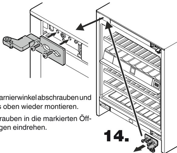
14. Scharnierwinkel abschrauben und links oben wieder montieren.
