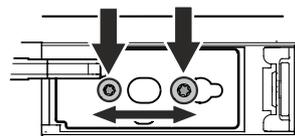
22. Schrauben lösen und Scharnierwinkel nach rechts oder links verschieben.
