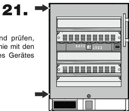
21. Tür schließen und prüfen, ob sie in einer Linie mit den Seitenwänden des Gerätes steht.
