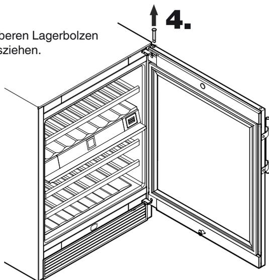
5. Die Tür zum Gerät hin bewegen, bis der Bolzen am Scharnierwinkel sichtbar wird (siehe Detailzeichnung).
