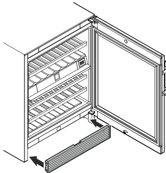
Das mitgelieferte Lüftungsgitter vorne aufsetzen und einrasten.
