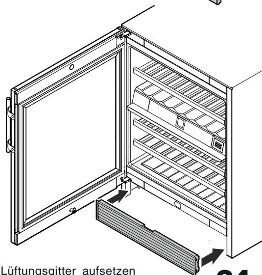
24. Lüftungsgitter aufsetzen und einrasten.
