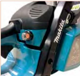
Primer Vergaser zum leichteren Start der Maschine
