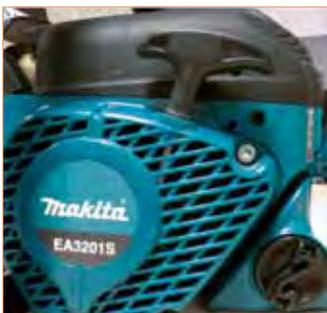
Feder-Leichtstart zur einfachen Überwindung des Kompressionswiderstandes
