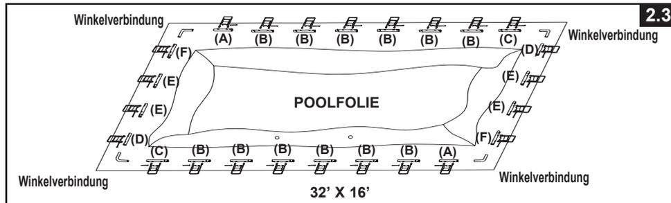
3. Versichern Sie sich, dass die Poolfolie geöffnet ist und in ihrer vollen Größe auf der Unterlagsplane ausgebreitet wurde. Beginnen Sie auf einer Seite, stecken Sie die "A" Balken zuerst in die Laschenöffnungen, welche sich in jedem Eck befinden. Fahren Sie mit den "B" Stangen fort, stecken Sie diese mit den "A" Stangen zusammen und die "C" Stangen gehören wiederum mit den "B" Stangen verbunden (siehe dazu Zeichnung 3).
