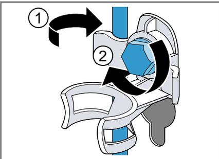
5. Den Schlauch in die Halterung einsetzen.
