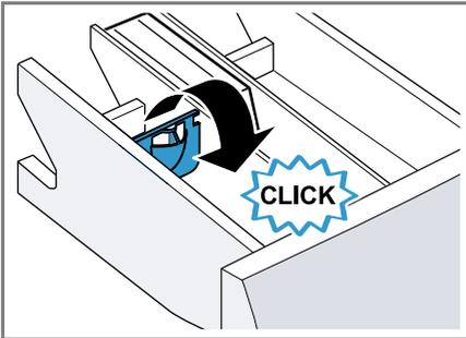
6. Die Waschmittelschublade einsetzen.
