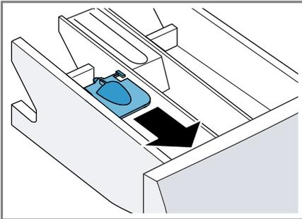
5. Die Dosierhilfe runterklappen und einrasten.
