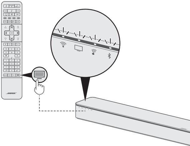
Die Soundbar wird neu gestartet und
