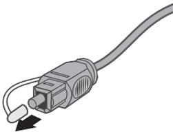
1. Schließen Sie ein Ende des optischen Kabels an den **Optical OUT**-Anschluss des Fernsehgeräts an.
