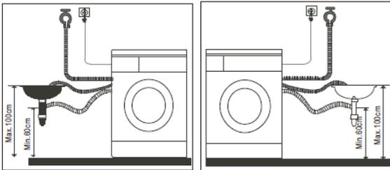
Der Abwasserschlauch befindet sich an der Hinterwand der Waschmaschine. Den Abwasserschlauch so absichern, dass er sich während des Betriebs der Waschmaschine nicht hin und her bewegt (den Bogen einsetzen - siehe unten). Den Abwasserschlauch nicht zu tief in das Abflussrohr einschieben!
