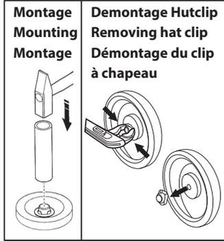
**D: Montage/Demontage Hutclip:** Der Hutclip läßt sich mit einer Zange abziehen.
