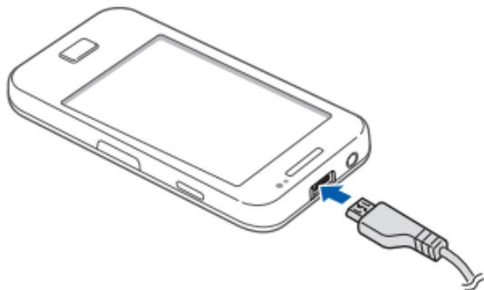
**!** Falsches Anschließen des Reiseadapters kann zu schweren Schäden am Gerät führen. Schäden durch unsachgemäße Verwendung sind von der Garantie nicht abgedeckt.
