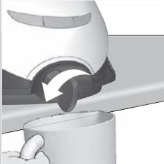
**4** Enlevez le bouton EASY DE-CALC et laissez l'eau avec des dépôts de calcaire s'écouler dans la tasse.
