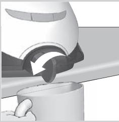
**3** Halten Sie eine Tasse mit einem Fassungsvermögen von mindestens 350 ml unter den EASY DE-CALC-Verschluss, und drehen Sie den Verschluss gegen den Uhrzeigersinn.
