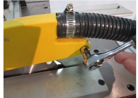
Sägeblattschutzabdeckung auf Spaltkeil aufsetzen, Absaug Schlauch anbringen und alle beide festschrauben.
