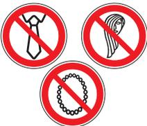
Wenn Sie an der Maschine arbeiten, tragen Sie keinen lockeren Schmuck, weite Kleidung, Krawatten oder langes, offenes Haar.
