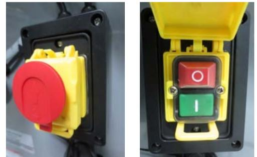
**INFO:** Im geschlossenen Zustand kann der Hauptschalter als **NOT AUS** Schalter betätigt werden
