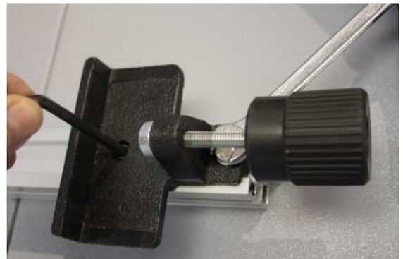
Den Adapter wie abgebildet auf das Aluprofil aufschrauben und in das Parallelanschlagführungsprofil einschieben.
