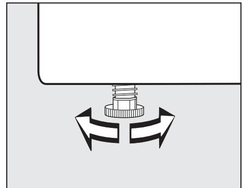
Durch Drehen der Schraubfüße werden Bodenunebenheiten ausgeglichen.
