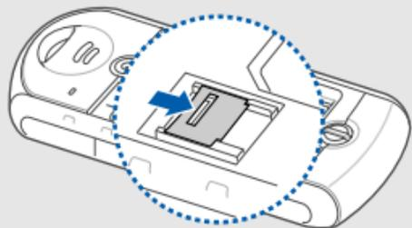
4. Heben Sie die Speicherkartenabdeckung an und legen Sie die Speicherkarte mit der Etikettenseite nach oben ein.
