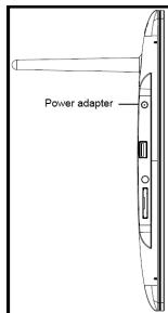
Verbinden Sie das mitgelieferte **Netzteil** mit dem Digitalen Fotorahmen (**DC-IN**). Stecken Sie das andere Ende des **Netzteils** in die **Steckdose**. Der Digitale Fotorahmen startet nun automatisch. Drücken Sie kurz die **Power-Taste**, um den Digitalen Fotorahmen auszuschalten oder erneut einzuschalten.
