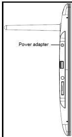
Соедините приложенный **блок питания** с цифровой фотопамятью (**DC-IN**). Вставьте другой конец блока питания в **розетку**. Цифровой фотопамяти включается автоматически. Держите кнопку включения **Power** на протяжении короткого времени нажатой, чтобы выключить или повторно включить ее.
