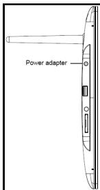
Connectez l'**adaptateur secteur** fourni à l'écran photo (**DC-IN**). Branchez l'autre extrémité de l'**adaptateur** dans la **prise**. L'écran photo démarre alors automatiquement. Maintenez la touche **power** brièvement enfoncée pour désactiver ou réactiver l'appareil.
