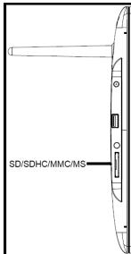
Вставьте карту памяти в гнездо устройства считывания карты, при этом логотип должен быть направлен в сторону, противоположную экрану.
