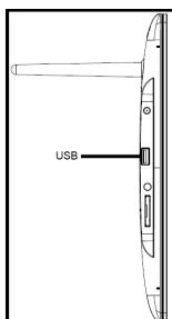
Das **USB Speichermedium** kann nur in einer Richtung in den USB Slot eingesetzt werden.
