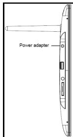
Conecte o transformador anexado com a moldura digital (**DC-IN**). Coloque a outra extremidade do **transformador na tomada**. A moldura digital inicia automaticamente. Mantenha a tecla **Power** pressionada por um curto espaço de tempo para a desligar ou voltar a ligar.
