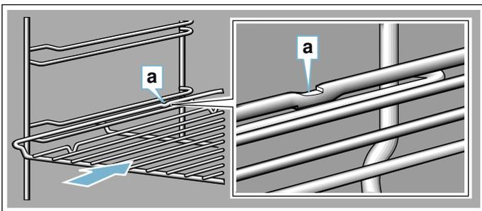
Achten Sie beim Einschieben von Blechen darauf, dass die Rastnase **a** hinten ist und nach unten zeigt. Die Abschrägung des Zubehörs **b** muss vorne zur Gerätetür zeigen.
