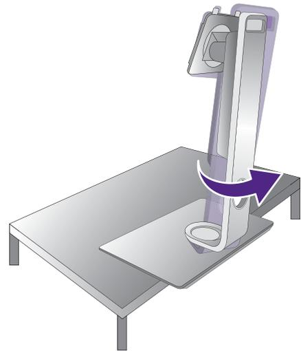
Entfernen Sie anschließend den Sockel vom Ständer.
