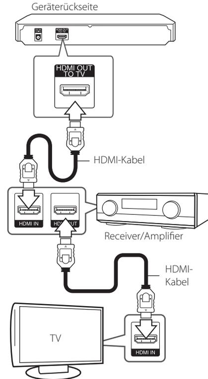
Falls Ihr Verstärker eine HDMI-Ausgangsbuchse besitzt, verbinden Sie diese Buchse über ein HDMI-Kabel mit der HDMI-Eingangsbuchse am Fernsehgerät.
