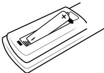
Nehmen Sie die Batterieklappe von der Rückseite der Fernbedienung ab und legen Sie die R03-Batterie (Größe AAA) mit der richtigen Polung **+** und **-** ein.
