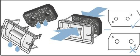
**Hinweis:** Achten Sie darauf, dass die Filtermatte nicht verformt, gerissen oder verstopft ist. Positionieren Sie die Filtermatte wie oben abgebildet.
