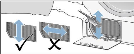
**Hinweis:** Achten Sie beim Reinigen darauf, dass Sie die Lamellen des Wärmetauschers nicht verbiegen oder beschädigen.
